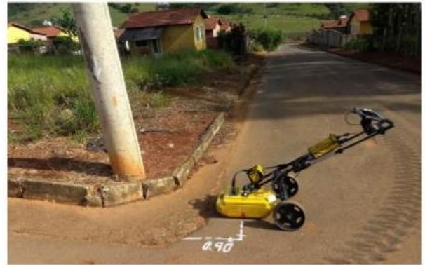
Foto 2 - GPR (GeoRadar) e marcação em piso
