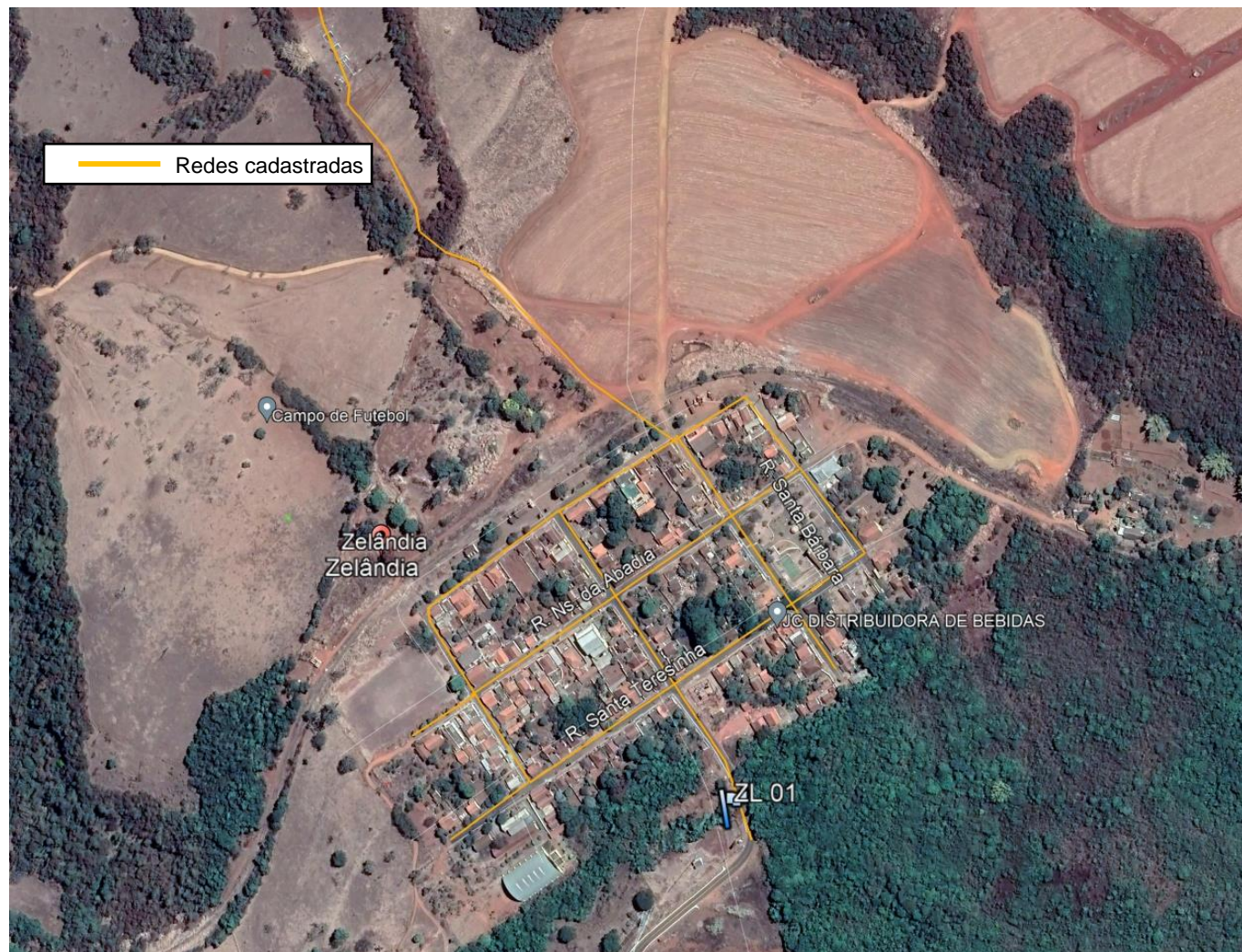
Figura 36 – Imagem ilustrativa referente ao traçado das redes do Sistema de Esgotamento Sanitário (ANEXO VII). Fonte: Obtida através de aerolevantamento realizado pela empresa Planal Tecnologia, Serviço e Engenharia Ltda., Dezembro/2020
